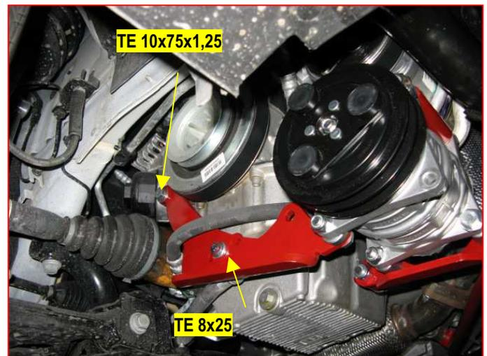
14. Montare il puntone "F" con la vite TE 10 x 80 x 1,25 (foto n. 15);
