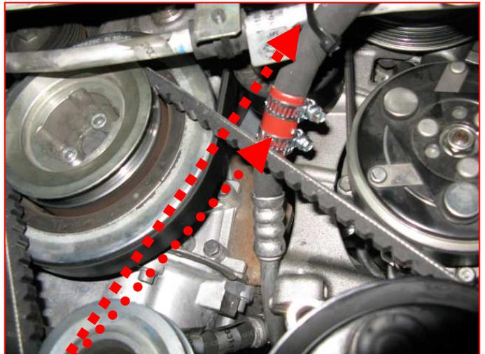
Fissare il tubo a/c alta pressione con il tubo in alluminio. Posizionare la protezione in acciaio fornita sul tubo a/c originale in prossimità del passaggio della cinghia e apporre le relative fascette, come indicato nella foto
