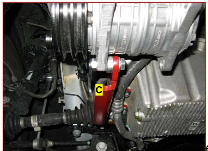
12. Montare il compressore (foto n. 11 e n. 12);
